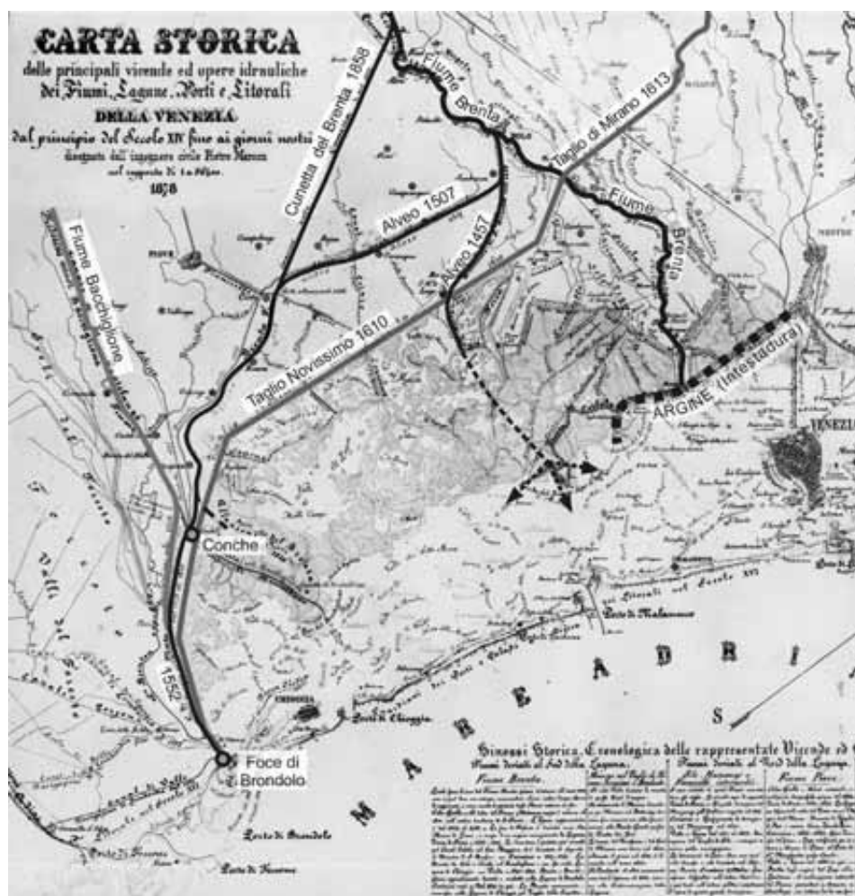
Fig. 1 – Gli interventi attuati dalla Repubblica di Venezia sul corso del Brenta, del Bacchiglione e di alcuni fiumi minori a difesa della laguna dagli interrimenti.
